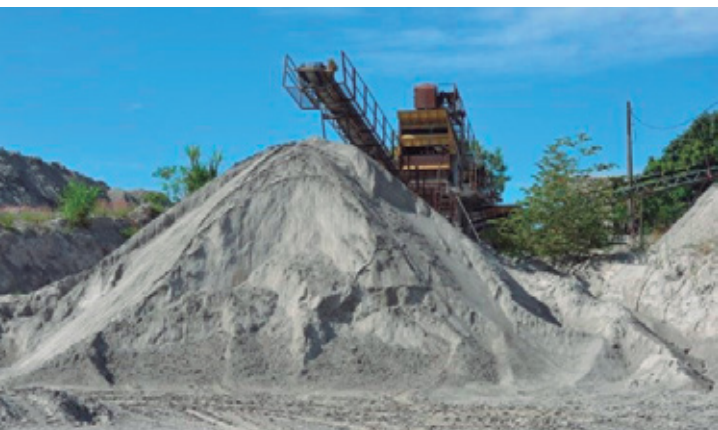
Fig. 1 - Britagem da rocha transformada em pó de rocha
